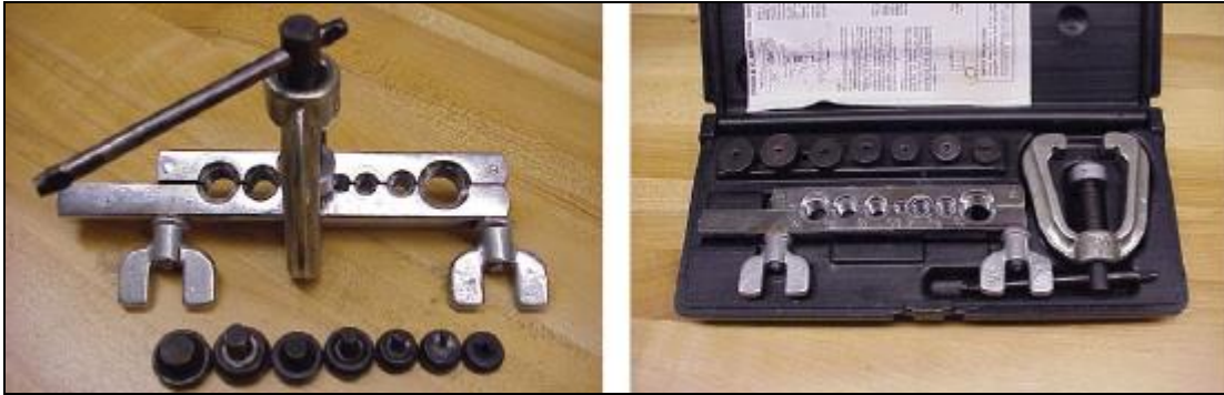
Figura 13: Ferramenta manual de flangear (flange simples).
