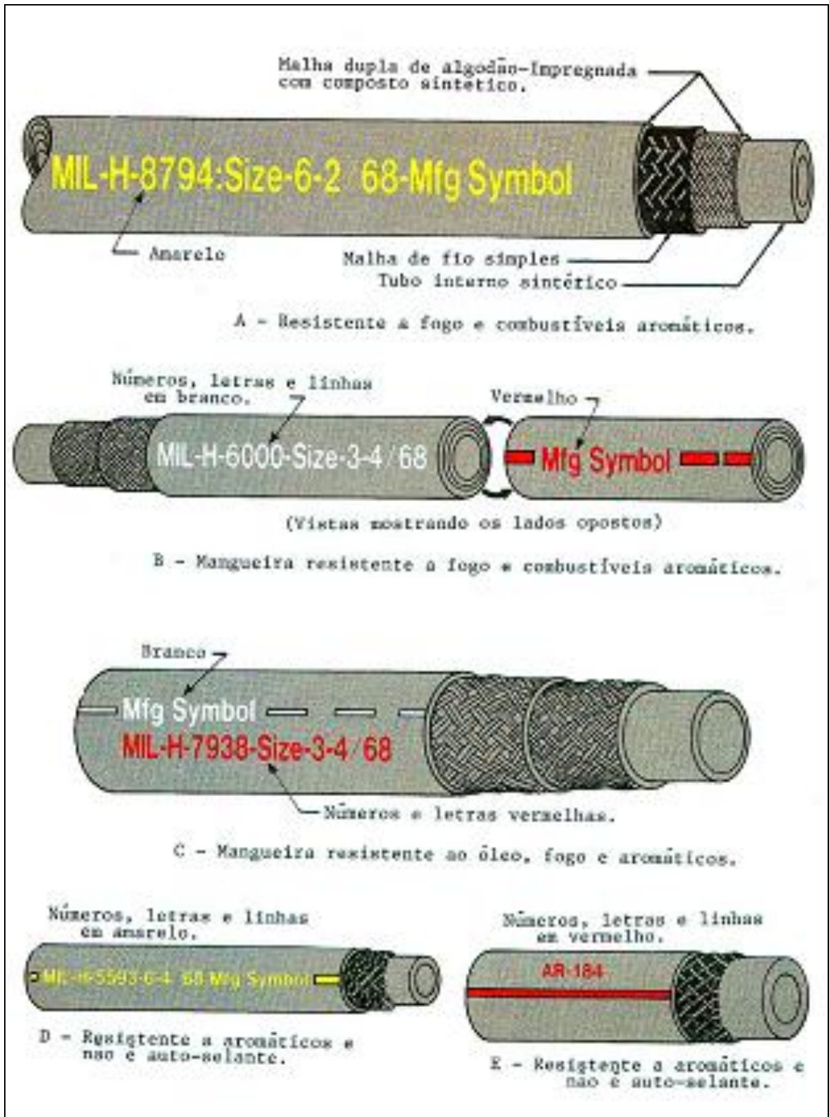
Figura 2: Identificação de tubulações flexíveis.
