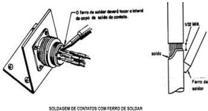
SOLDAGEM DE CONTATOS COM FERRO DE SOLDAR
