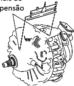
Figura 8-10 Motor com a eslinga (estropo) de suspensão instalada
