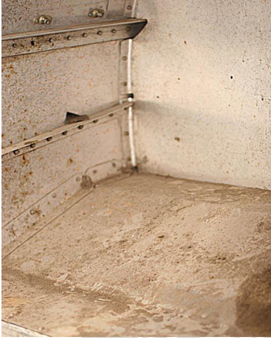
Fonte: FAA - Federal Aviation Administration - Mechanic Training Handbook Ataque químico direto em um compartimento da bateria
