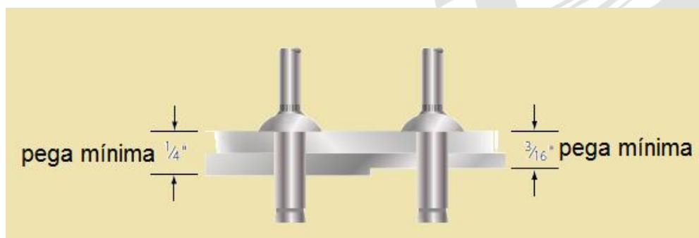
Figura 6-44 Comprimento típico de "pega".
