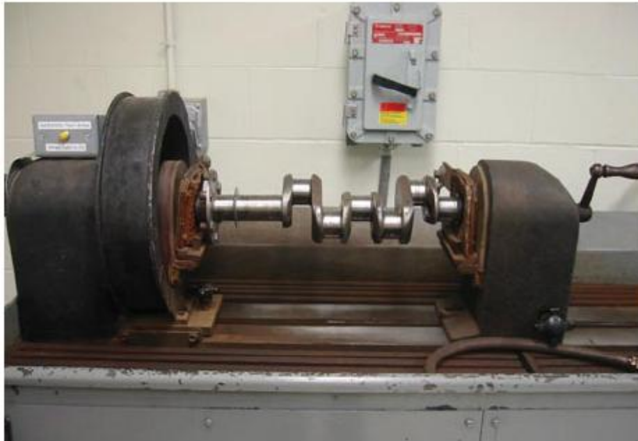
Figura 10-4 Magnetização circular de um eixo manivela.
